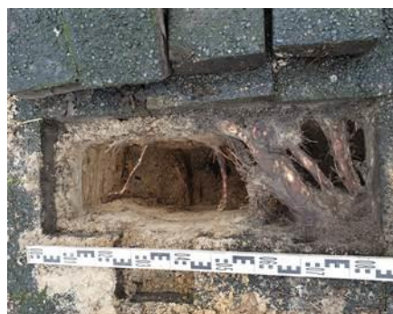
Afbeelding 34: zeer intensieve beworteling op 8 tot 18 cm/-mv
