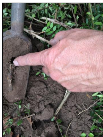
Grondboring tegen de gevel van het huidige ERF gebouw.
