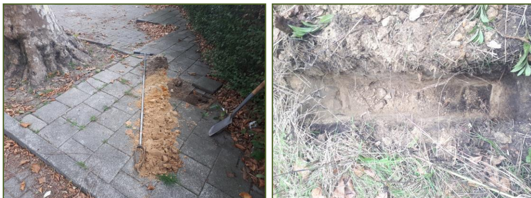
Afbeelding 8 en 9: Links de grondboring t.h.v. boom 10 (trottoir) met daarin het bodemprofiel zoals homogeen door het gehele projectgebied aangetroffen. Rechts profielsleuf waarin met name in de toplaag fijne wortels zijn aangetroffen. In diepere lagen zijn enkele fijne wortels tot aan de capillaire zone (2,1 m -mv) aangetroffen.
