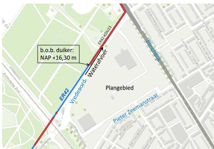
Afbeelding 2.1: Watergang met afvoerrichting en reeks duikers in beheer van waterschap [6]
