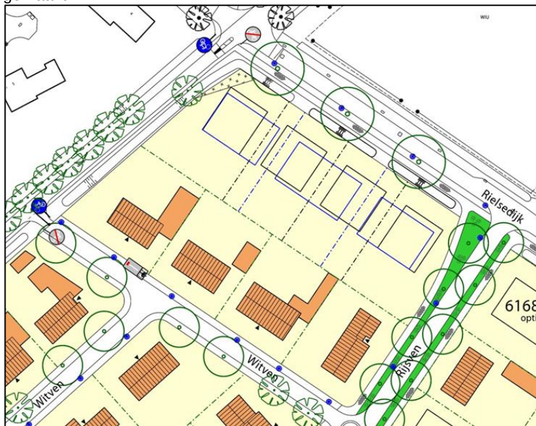
Afbeelding verschil verkaveling. Blauwe lijnen zijn de oorspronkelijke verkaveling met bouwvlakken. De zwarte lijnen zijn de bouwvlakken en de nieuwe verkaveling die dit bestemmingsplan mogelijk maakt.
