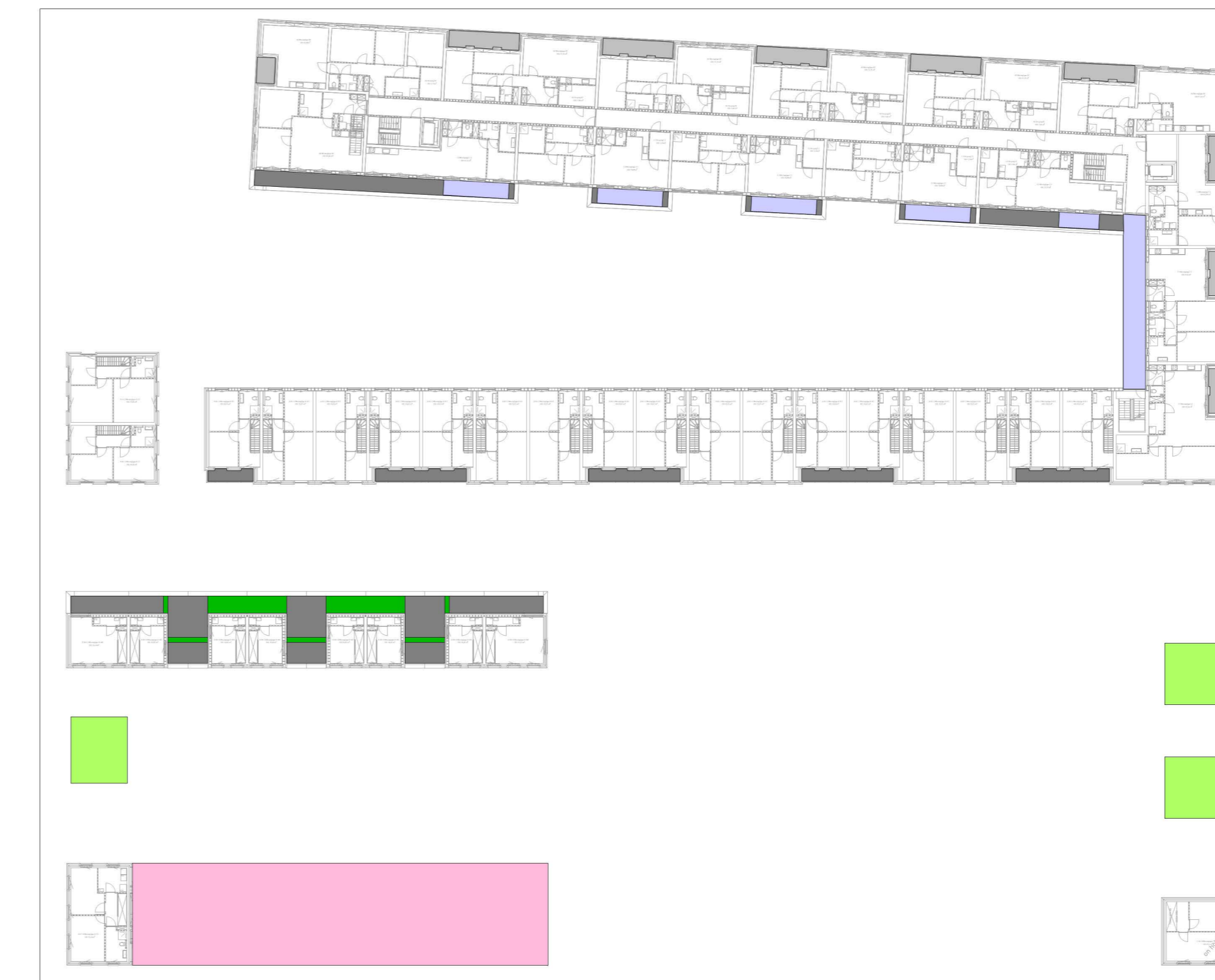
2e verdieping: 35 m2 groen met buffercapaciteit 210 m2 verharding niet overluisd met buffercapaciteit 86 m2 verharding overluisd met buffercapaciteit 90 m2 verharding overluisd 122 m2 sedumdak 435 m2 schuin dak
