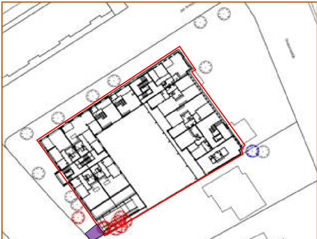
Afbeelding 14: Overzicht ontwerptekening op maaiveldniveau. Op de rode lijn zal een damwand geslagen worden. In paars de toerit.
