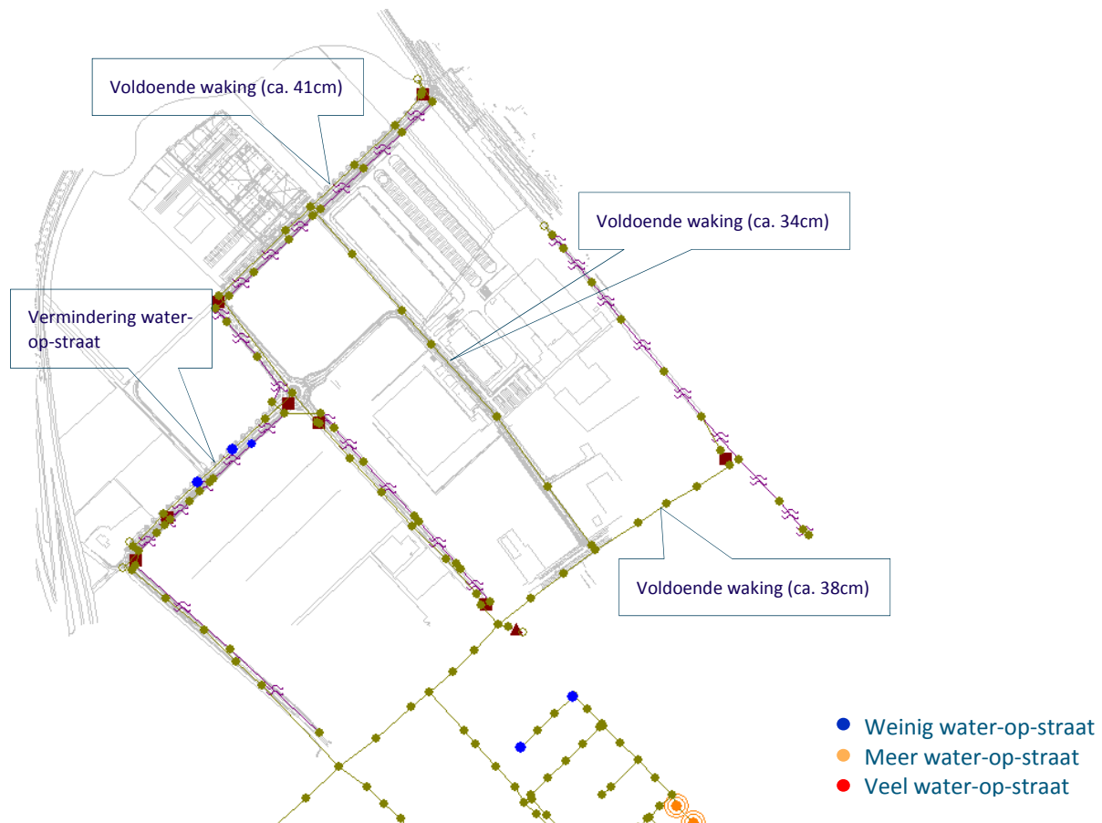
Figuur 7: Resultaten bij een bui 08 conform Leidraad Riolerings- Maatregelen 1A, 1B en 1C; Verdiepen watergang Achtseweg-Noord tot NAP 16,8+, aanbrengen uitlaat westzijde Mispelhoefstraat NAP +17,2m (breedte 2m) en verlagen ALLE uitlaten op NAP +17,0m. Gerekend met een LEGE retentie op NAP +16,8m
