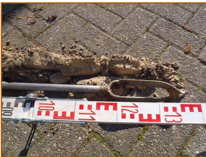
Afbeelding 4. Grondboring 1, grondwater op 130 cm beneden maaiveld
