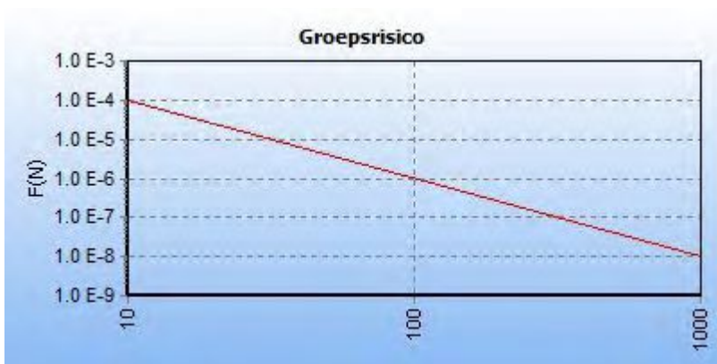
5.11 Figuur 5.11 FN curve voor Z-519-06 van N.V. Nederlandse Gasunie voor de kilometer tussen stationing 0.00 en stationing 750.00
