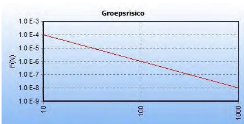
5.11 Figuur 5.11 FN curve voor Z-519-06 van N.V. Nederlandse Gasunie voor de kilometer tussen stationing 0.00 en stationing 750.00
