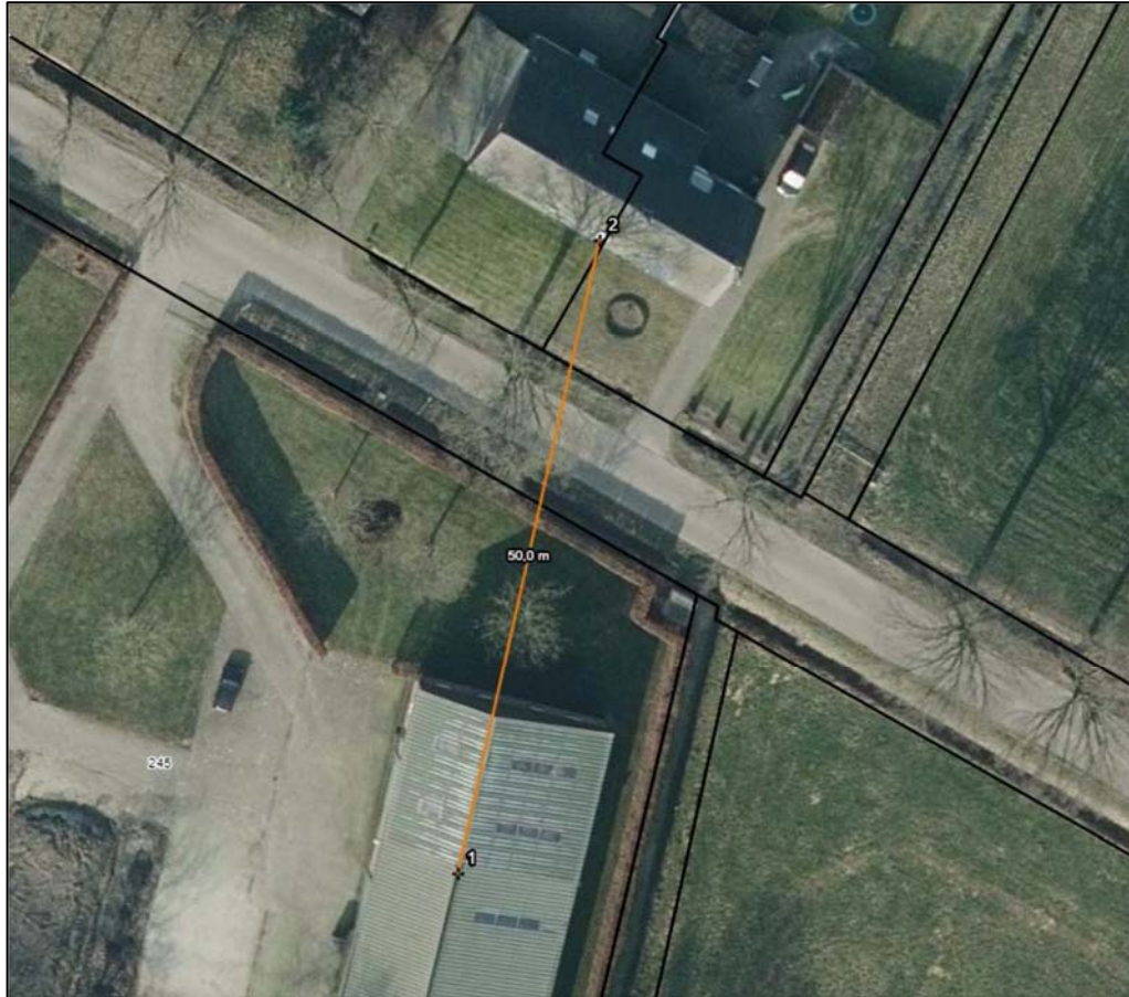
Figuur 8 afstand 50 meter tussen gevel woning en meest nabijgelegen emissiepunt van de stal Voor het uitgebreide rapport wordt verwezen naar de bijlagen.
