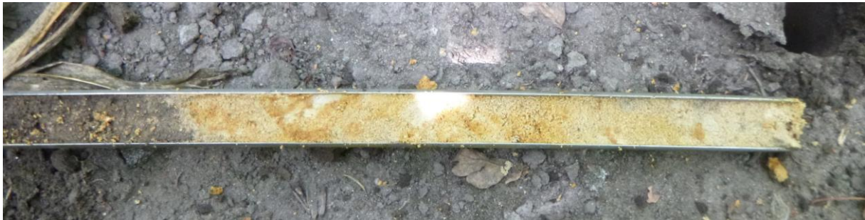
Figuur 24: Foto van de C-horizont met gley-verschijnselen zoals deze onderin alle boringen is aangetroffen.
