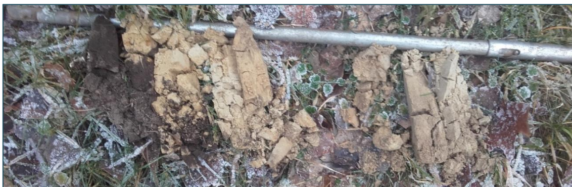
Abbeelding 4 Boormonsters boring 3998003; de scherpe overgang van de geroerde toplaag naar het moedermateriaal vindt plaats op 15 centimeter beneden maaiveld. Bron: foto Vestigia (22 januari 2019).
