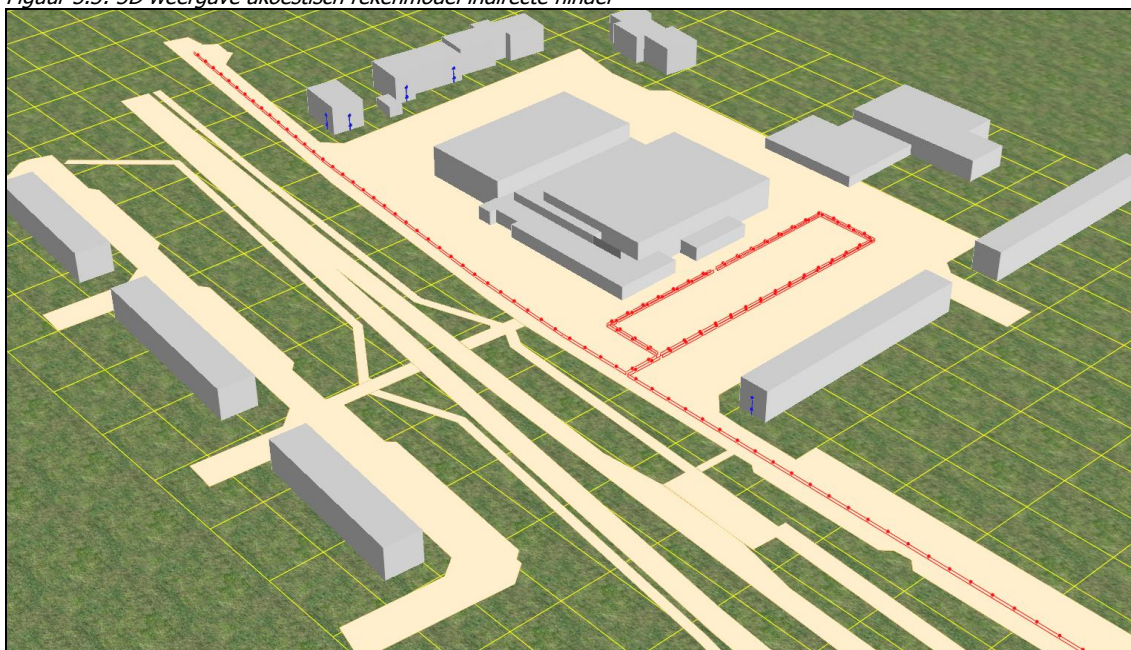
Figuur 5.3: 3D weergave akoestisch rekenmodel indirecte hinder
