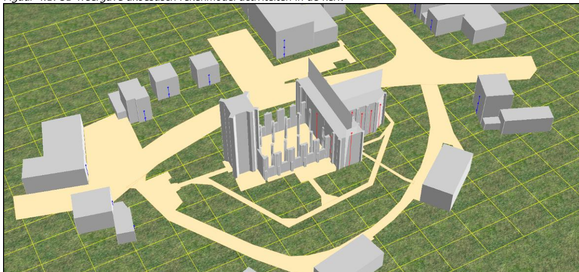
Figuur 4.1: 3D weergave akoestisch rekenmodel activiteiten in de kerk
