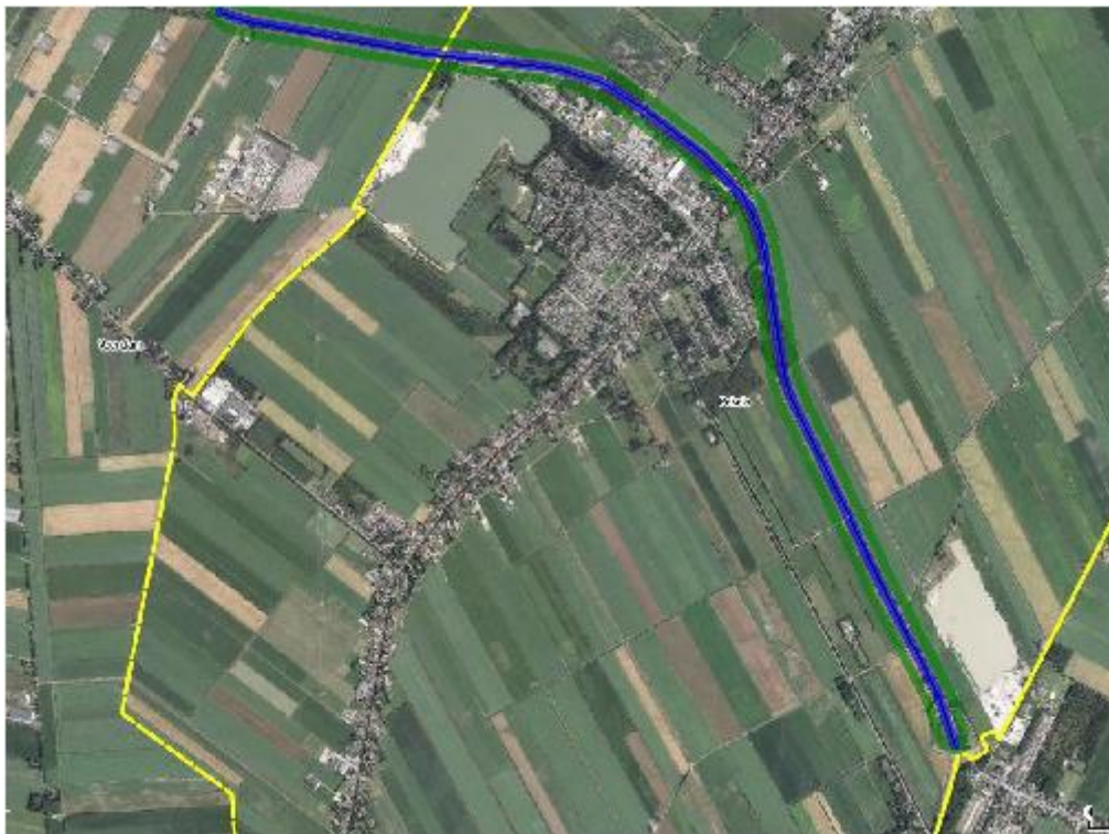
Figuur 11: Plaatsgebonden risico (PR 10^{-7} in blauw, 10^{-8} in groen) deelroute 2
