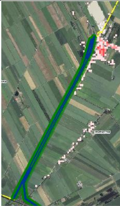
Figuur 10: Plaatsgebonden risico (PR 10^{-7} in blauw, 10^{-8} in groen) deelroute 1
