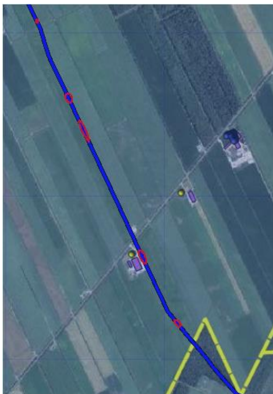
Figuur 21: N-523-80-Deel 1 plaatsgebonden risico 10^{-6} rood
