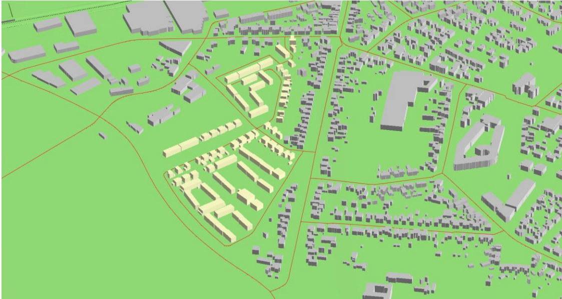
figuur 4: 3D-overzicht van het akoestisch rekenmodel, met het betreffende plan in het geel weergegeven
