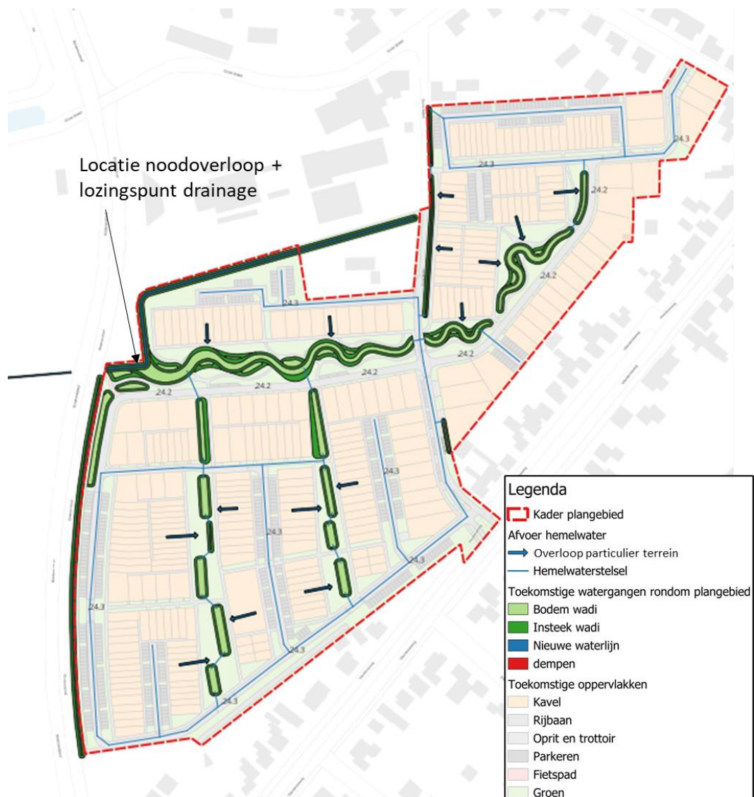
Figuur 6-1: Overzicht hemelwaterafvoer en indicatieve maaiveldhoogtes
