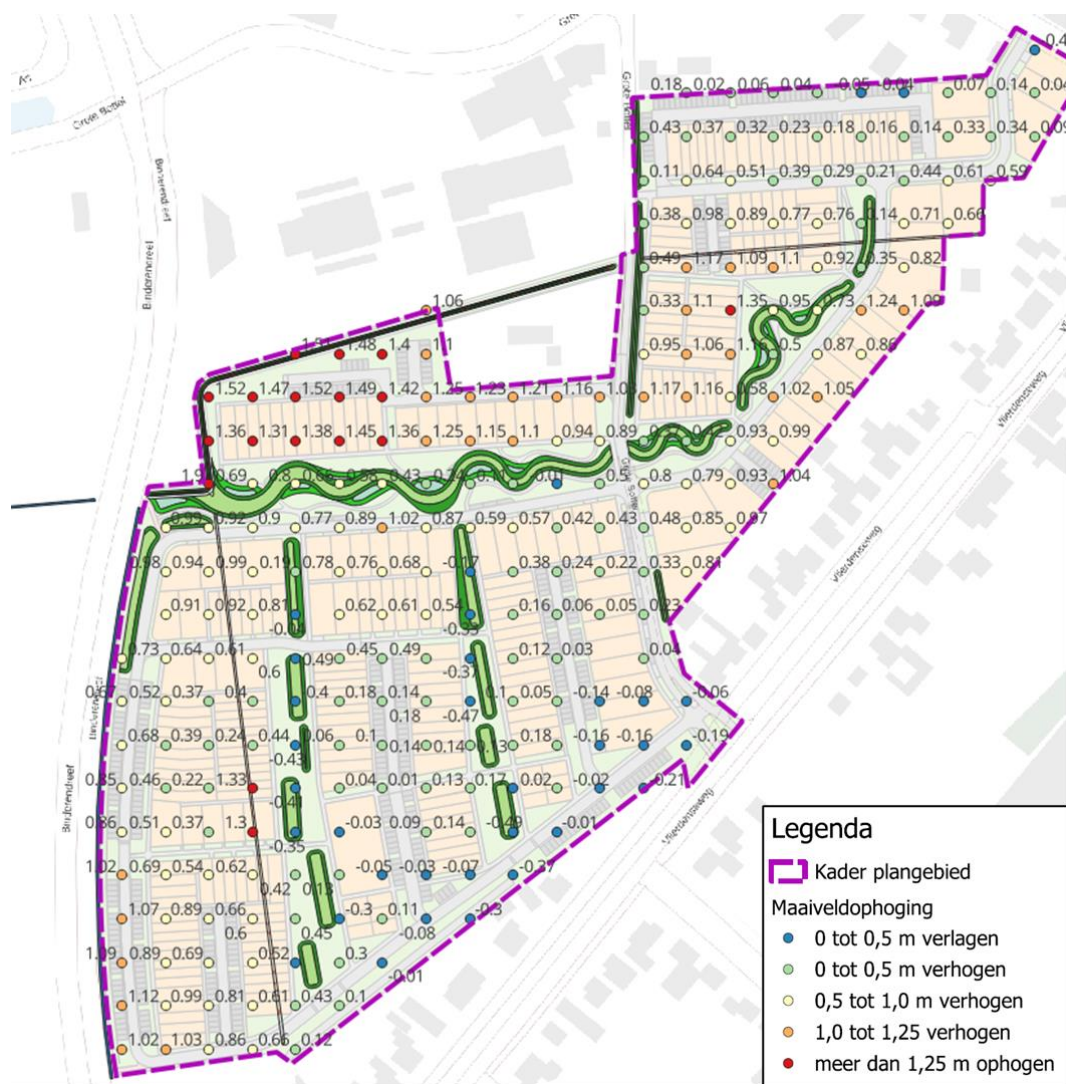
Figuur 5-1: Benodigde ophoging om te voldoen aan minimale ontwateringseisen
