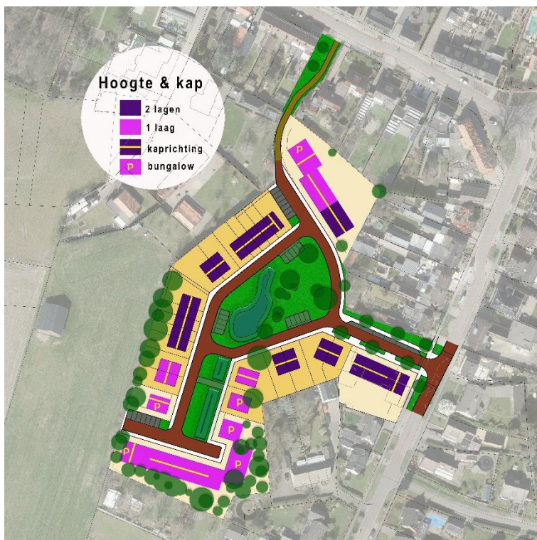
Hoogten en kapvorm van woningen
