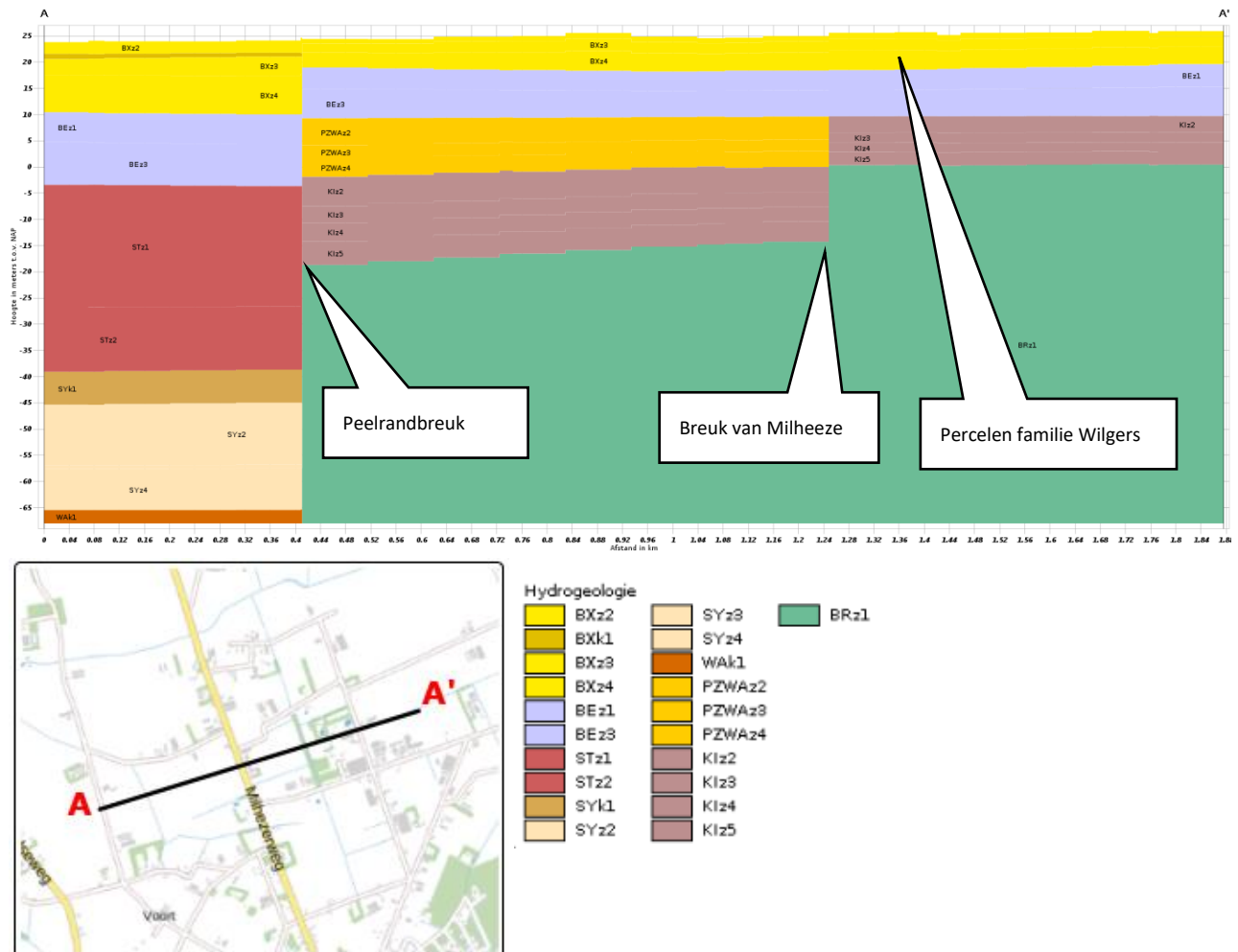
Figuur 2 Hydrogeologische dwarsdoorsnede over de percelen van de familie Wilgers, de Breuk van Milheeze en de Peelrandbreuk (bron: DINOloket, REGIS II v2.2).
