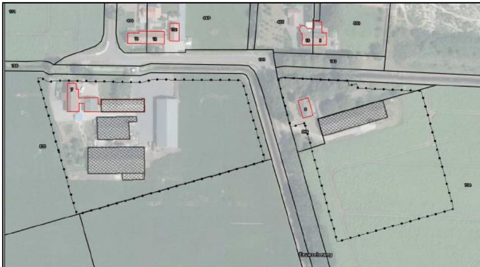
Figuur 2. Overzicht van de te slopen bebouwing ( gearceerd) in het plangebied.
