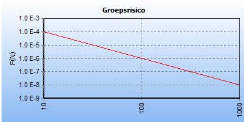
5.2 Figuur 5.2 FN curve voor 6192_leiding-Z-541-25-deel-1 van N.V. Nederlandse Gasunie voor de kilometer tussen stationing 0.00 en stationing 1000.00
