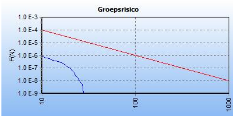
5.2 Figuur 5.2 FN curve voor 6192_leiding-Z-541-25-deel-1 van N.V. Nederlandse Gasunie voor de kilometer tussen stationing 0.00 en stationing 1000.00
