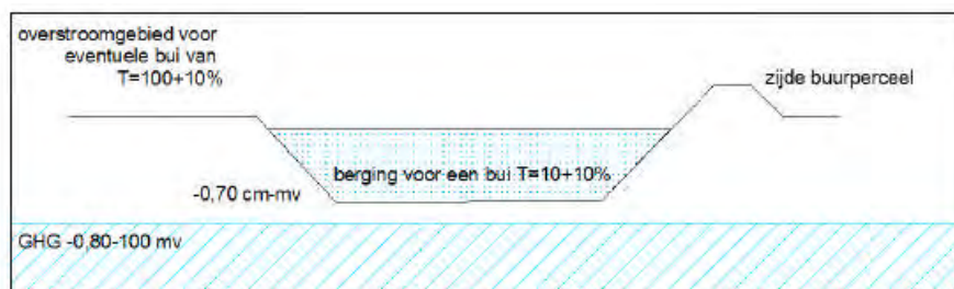
Schematische weergave mogelijke infiltratiesloot
