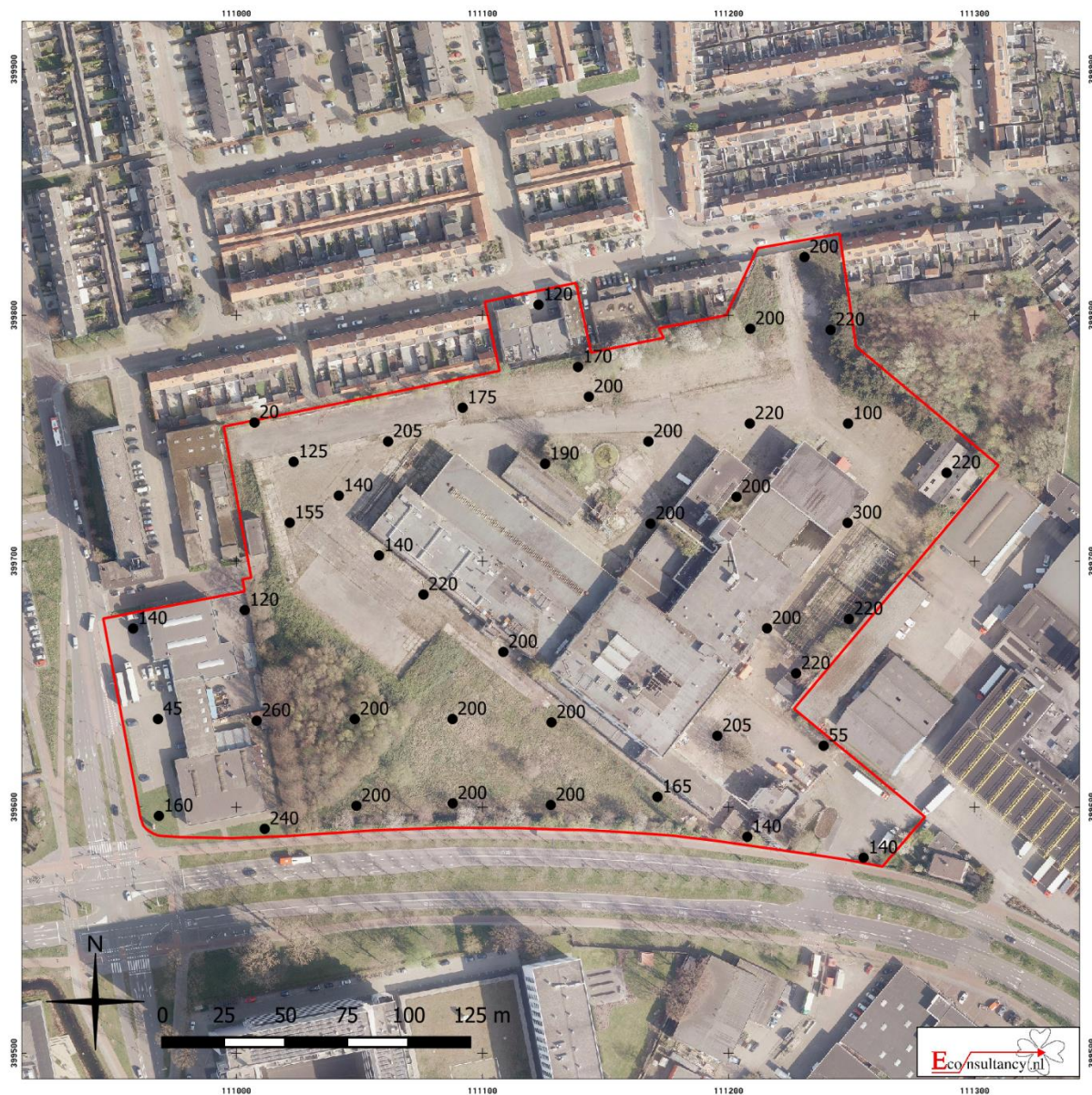
Afbeelding 5 Boorpuntenkaart met verstoringdiepte (cm -mv)
