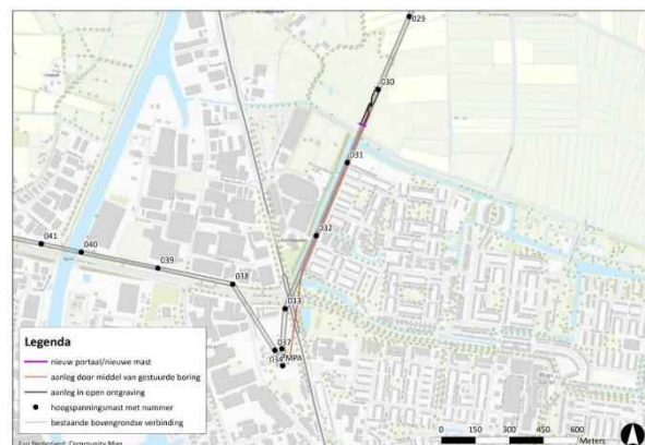
Figuur 1.3: 150 kV-kabelverbinding Geertruidenberg-Breda
