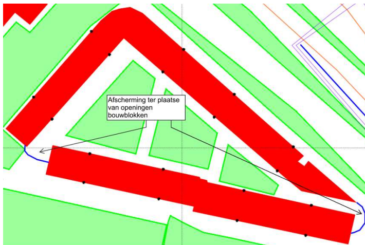
Figuur 4: Geluidmodel met afscherming t.p.v. openingen bouwblokken
