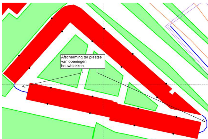
Figuur 4: Geluidmodel met afscherming t.p.v. openingen bouwblokken
