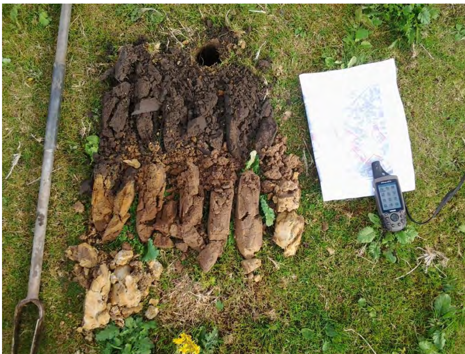
Figuur 3.6. Bodemopbouw ter hoogte van boring 6.
