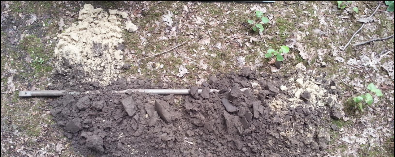
Figuur 7: Het profiel van boring 4 (leesrichting van links naar rechts, van onder naar boven).
