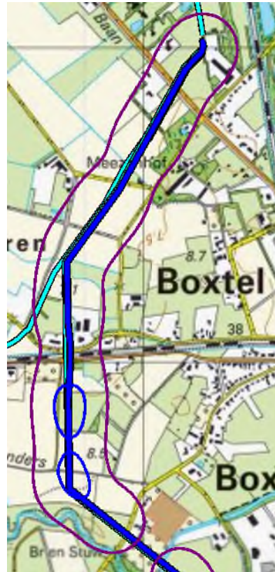
Figuur B1.3 PR 10^{-7} - (blauw) en PR 10^{-8} -contour van leiding A-525-05
