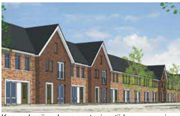
Kapverdraaiing, hoge goot, eigentijdse vormgeving gevelopeningen, deuroplijsting, wisseling gevelkleur
