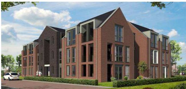
Groter gebouw opgeknipt in kleinere volumes met tussenleden, verschillende kleuren baksteen, kappen en verticale plat afgedekte elementen
