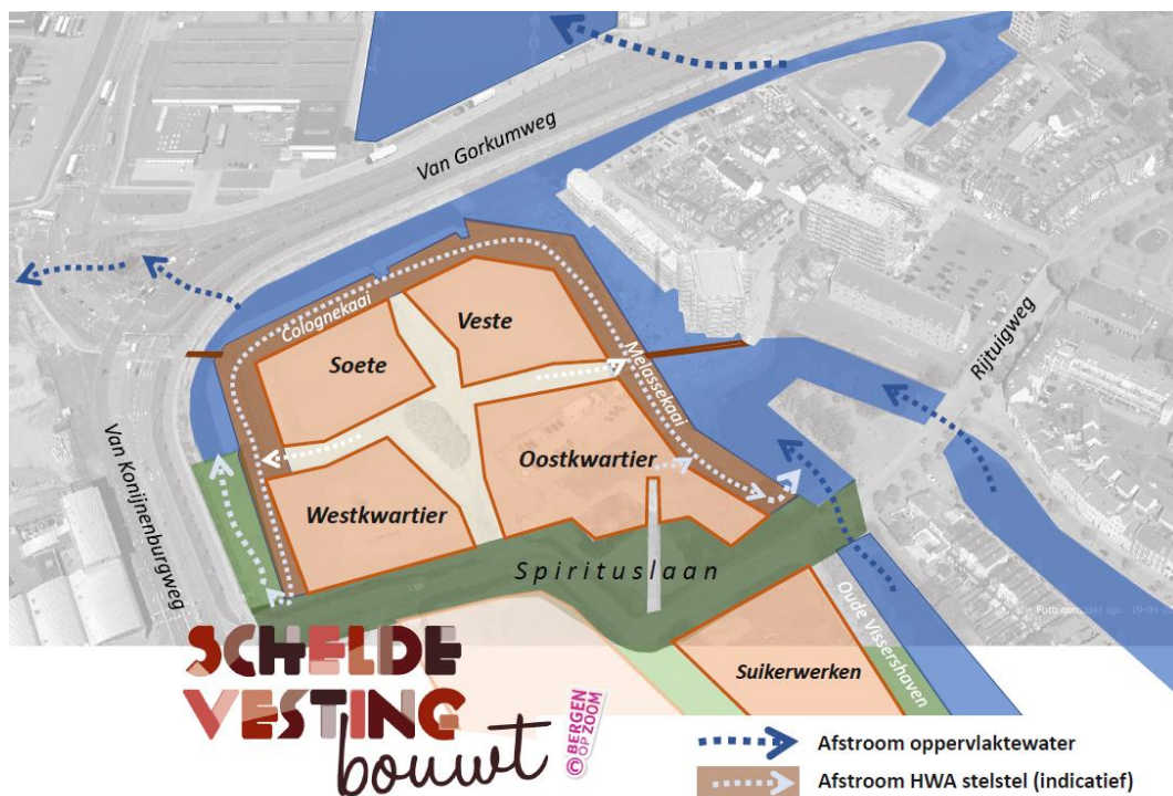
Figuur 9. Watersysteem fase 2 Nieuwe Vesting
