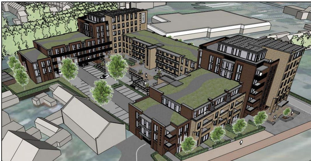
Figuur 2.7: Mos-sedumdaken op verschillende bouwlagen (Bron: Ingenieursburo AKM).
