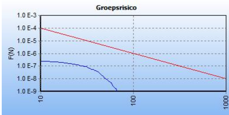
Figuur 8: FN curve behorend bij de boven aangegeven kilometer leiding.
