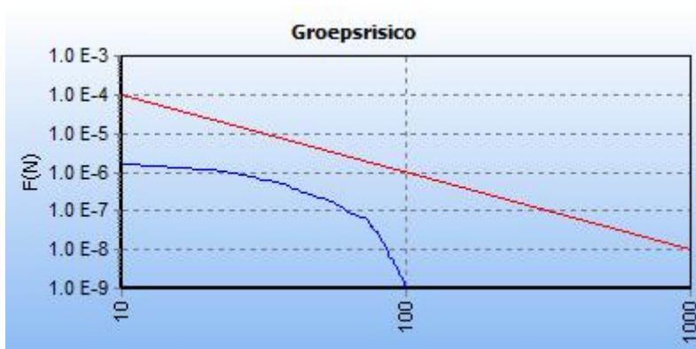
Figuur 6: FN curve behorend bij de boven aangegeven kilometer leiding.
