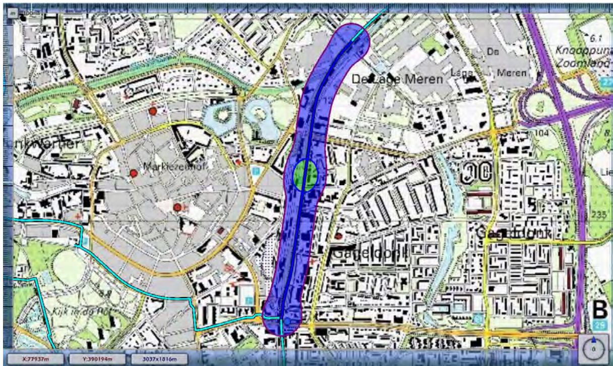
Figuur : De plaatsgebonden risicocontouren van de leiding Z-526-16 (groene contour is de PR 10^{-7} paars is de 10^{-8} )
