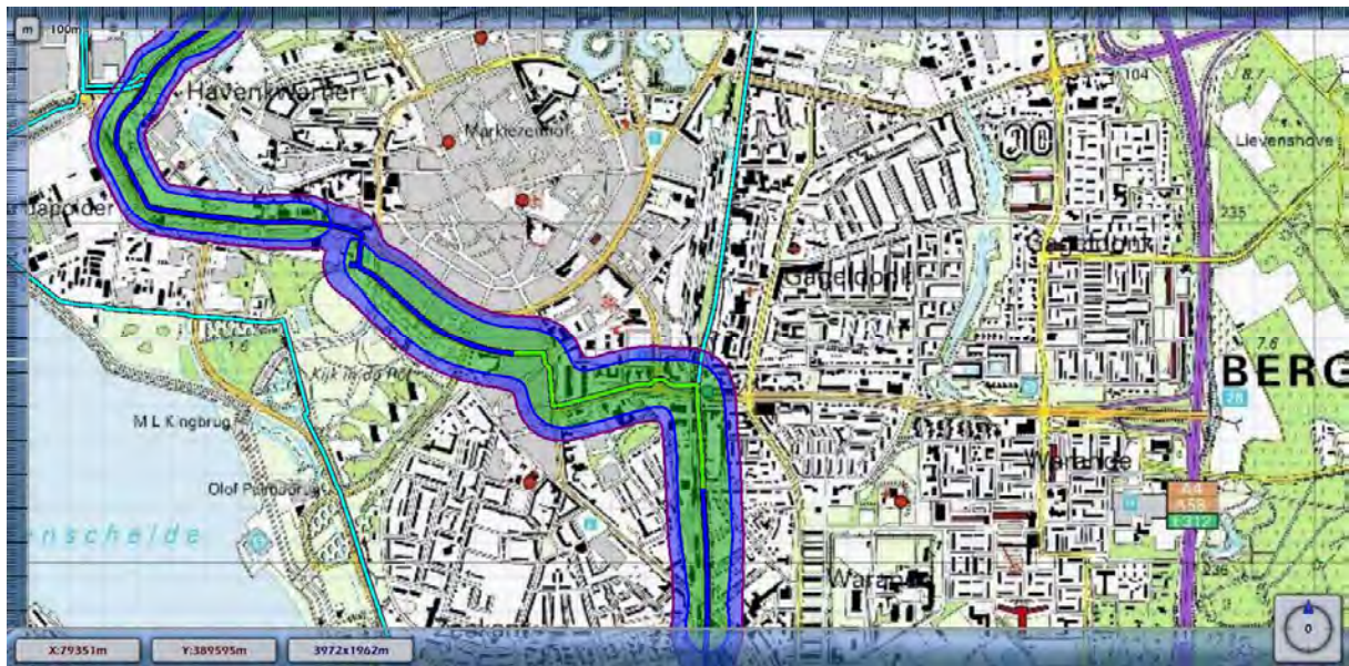
Figuur : De plaatsgebonden risicocontouren van de leiding Z-526-01 (groene contour is de PR 10^{-7} paars is de 10^{-8} )
