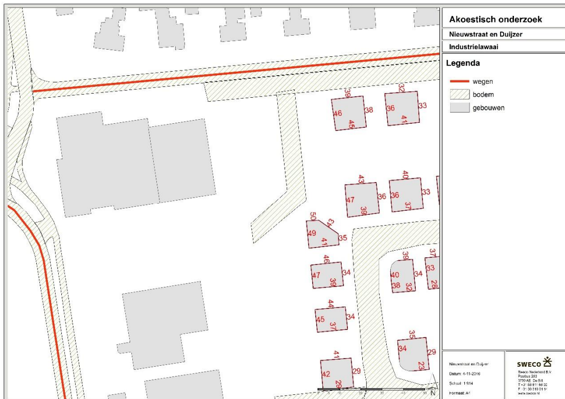
Figuur 4-1 Geluidbelasting vanwege het koopcentrum Duijzer op de nieuw te bouwen woningen
