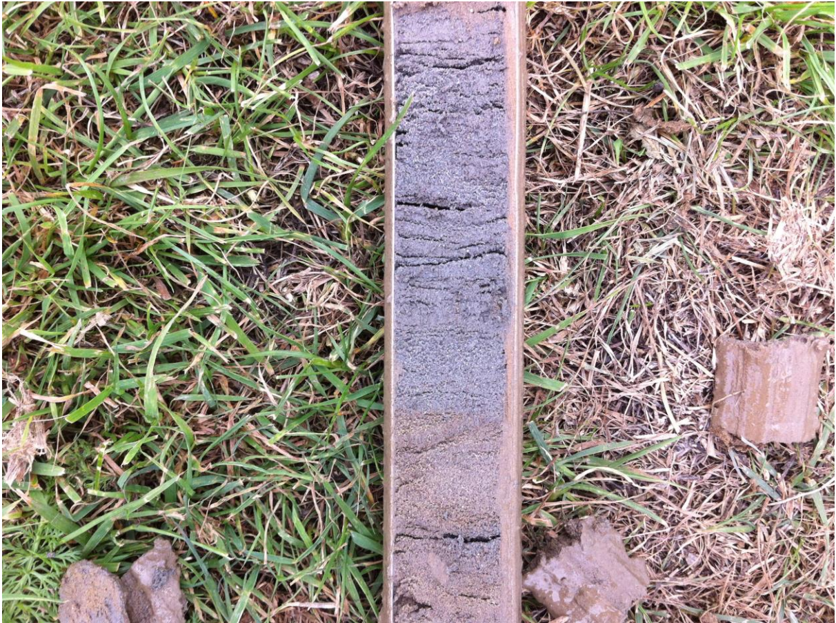
Opname van boring 15. Gelaagde opbouw van het zand
