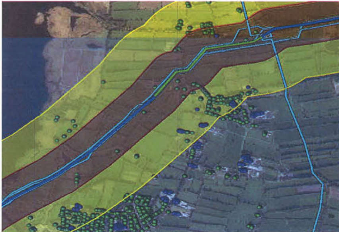
Figuur 2: populatiepolygonen voor bepaalde kilometer GR in invloedsgebied (bruin = 100% letaal, geel = 1% letaal)
