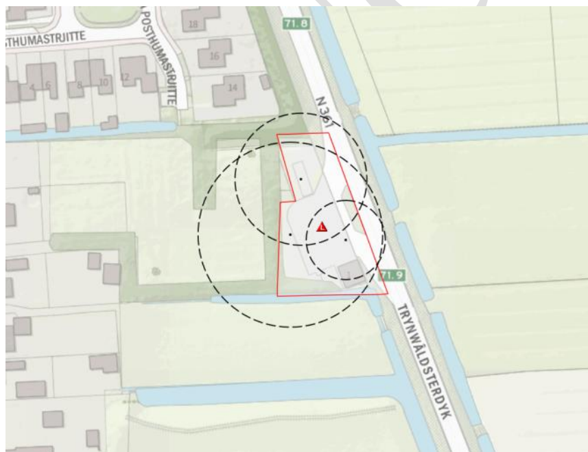
Figuur 9: Plaatsgebonden Risicocontouren LPG-tankstation Kramerswei
