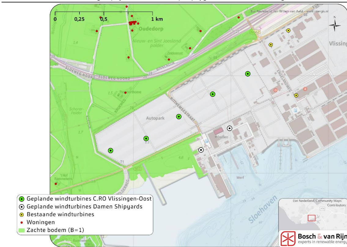
Figuur 2 Bodemabsorptie en –reflectie rondom het windpark. Bron: Bestand Bodemgebruik 2012. Standaard is gerekend met een harde, reflecterende bodem (B=0). Gebieden met een zachte bodem (groen in onderstaande figuur) zijn als absorberend (B=1) opgenomen in de berekening.
