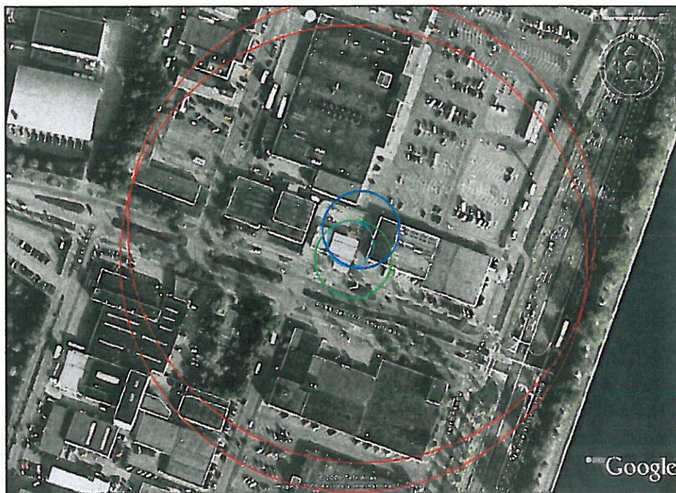
Figuur 4.2b PR 10^{-6} /jaar-contouren: Groen (vulpunt): 25 meter; donkerblauw (ondergrondse tank): 25 meter; middelblauw (afgifte punt) : 15 meter. Tevens in deze figuur de invloedsgebieden rondom vulpunten (150 m) en ondergrondse tank (150 meter). Situatie volgens Revi 2007 geldig na 1 januari 2010 of zoveel later als nodig is voor brede invoering hittewerende coating op LPG-tankwagens. Vergunde doorzet 500 \text{ m}^3/\text{jaar} .
