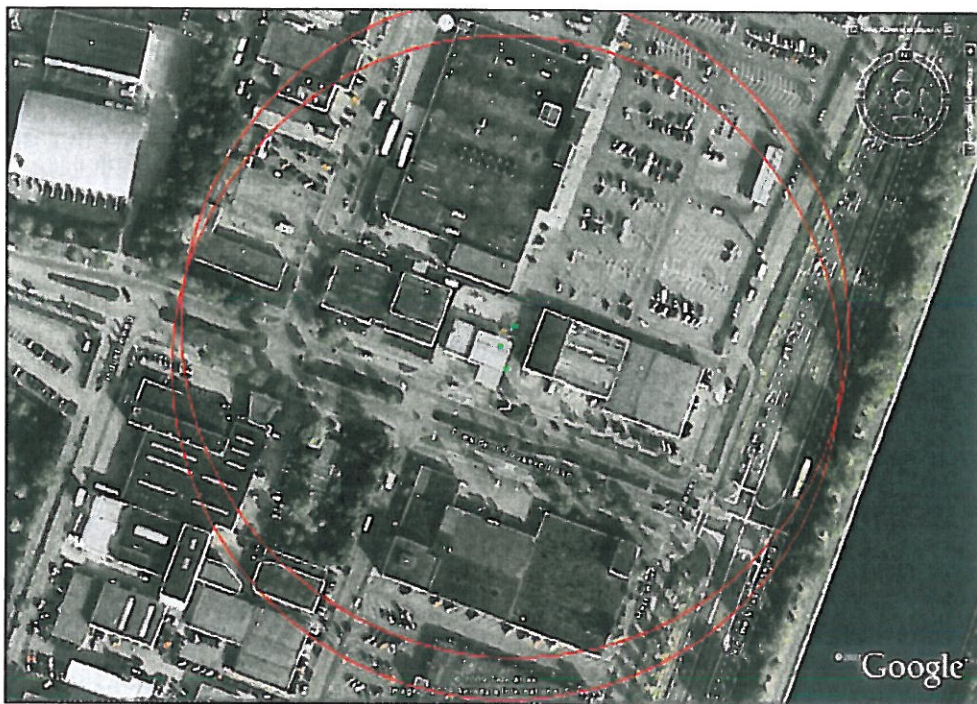
Figuur 2.1c Omgeving van het Shell Servicestation Roosevelt en invloedscircels rondom het vulpunt en om de ondergrondse tank. Groene punten: van boven naar beneden: tank, afgifte punt en vulpunt.
