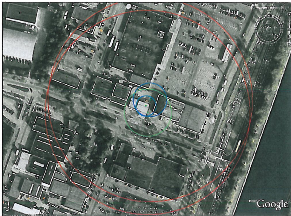
Figuur 4.2a PR 10^{-6} /jaar-contouren: Groen (vulpunt): 35 meter; donkerblauw (ondergrondse tank): 25 meter; middelblauw (afgiftepunt) : 15 meter. Tevens in deze figuur de invloedsgebieden rondom vulpunten (150 m) en ondergrondse tank (150 meter). Situatie volgens Revi 2007 geldig na 1 januari 2010 of zo veel later als nodig is voor brede invoering hittewerende coating op LPG-tankwagens. Vergunde doorzet 1000 \text{ m}^3/\text{jaar} .
