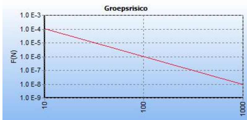
Figuur 7 | Voorbeeld van een fN-curve voor het groepsrisico
