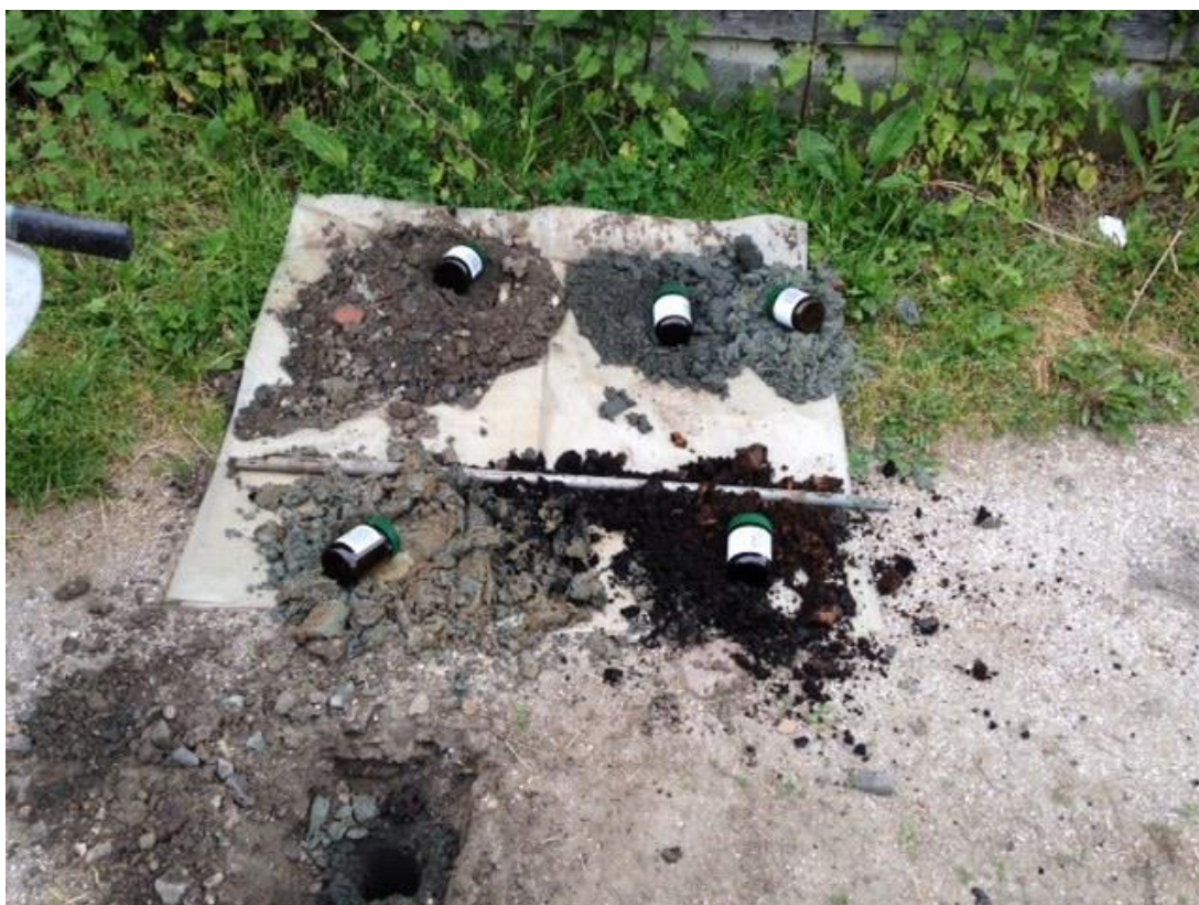
Foto 2. Boring 701 met puin in de topalaag.
