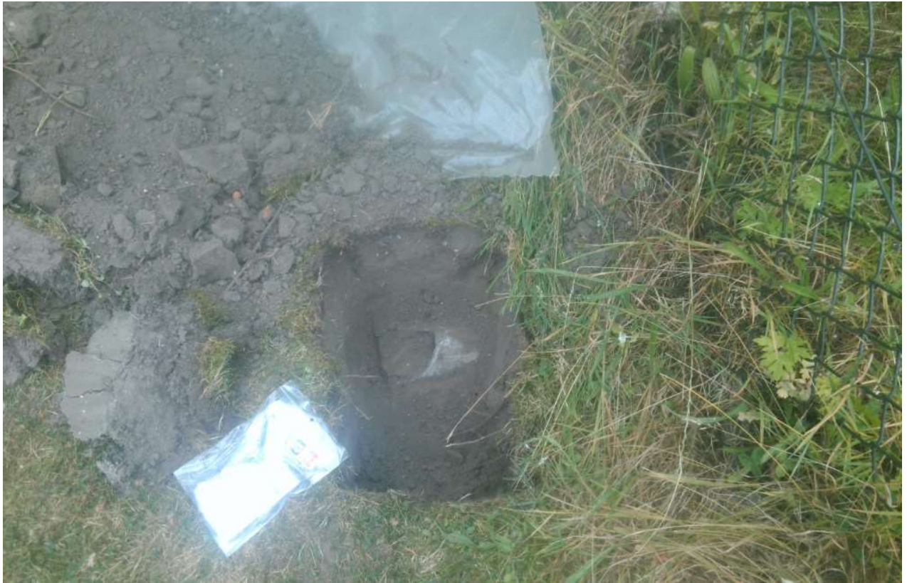
Foto 1: Asbesthoudende afvoerpijp bij peilbuis 2 met rechts het hek
