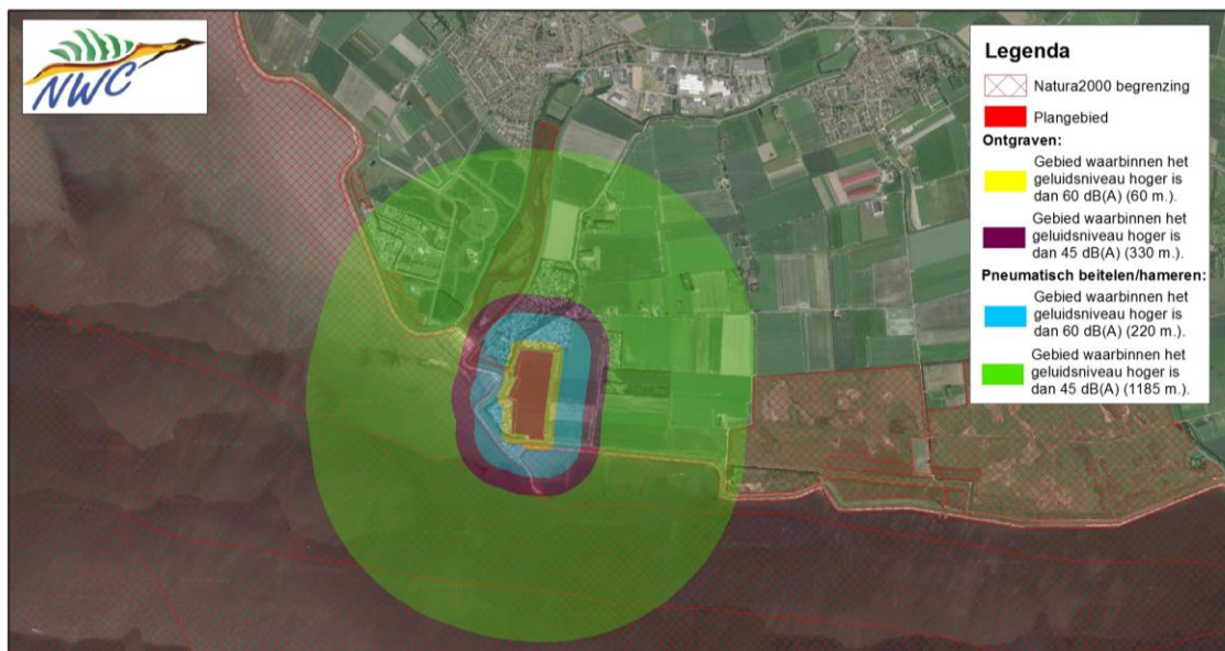
Figuur 6.2: Geluidscontouren geluidsniveau ontgraven en pneumatisch beitelen/hameren
