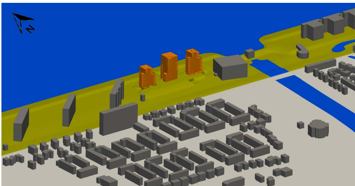
Figuur 4.1: 3D-rekenmodel ten behoeve van CFD-onderzoek
