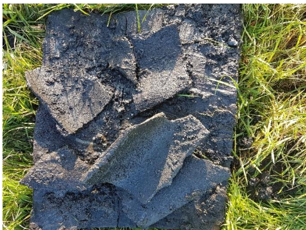
Foto 7: Zintuiglijke waarneming van asbest gedrenkt in teer
