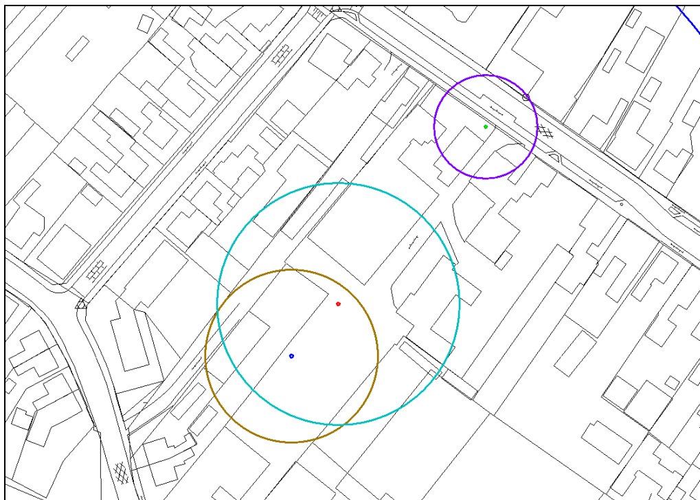
Figuur 4.2 Plaatsgebondenrisicocontouren van het LPG-tankstation: lichtblauw: 35 meter rondom LPG vulpunt bruin: 25 meter rondom ondergrondse tank paars: 15 meter rondom afgiftepunt
