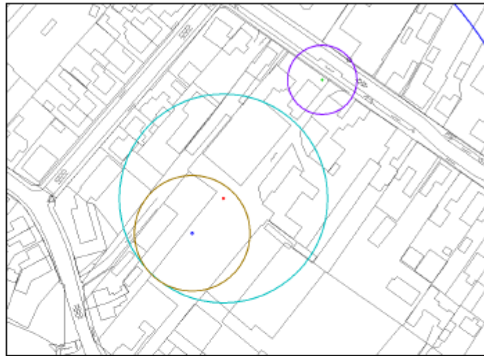
Figuur 4.1 Plaatsgebonden risicocontouren van het LPG-tankstation: lichtblauw: 45 meter rondom LPG-vulpunt bruin: 25 meter rondom ondergrondse tank paars: 15 meter rondom afgiftepunt
