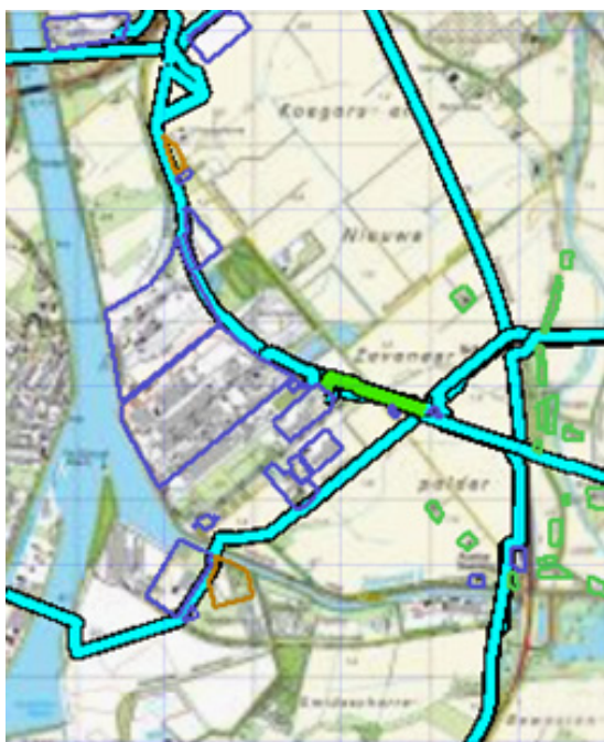
Figuur 5.2 Kilometer leiding behorende bij de maximale overschrijding van de FN-curve voor A-530-09 van N.V. Nederlandse Gasunie
