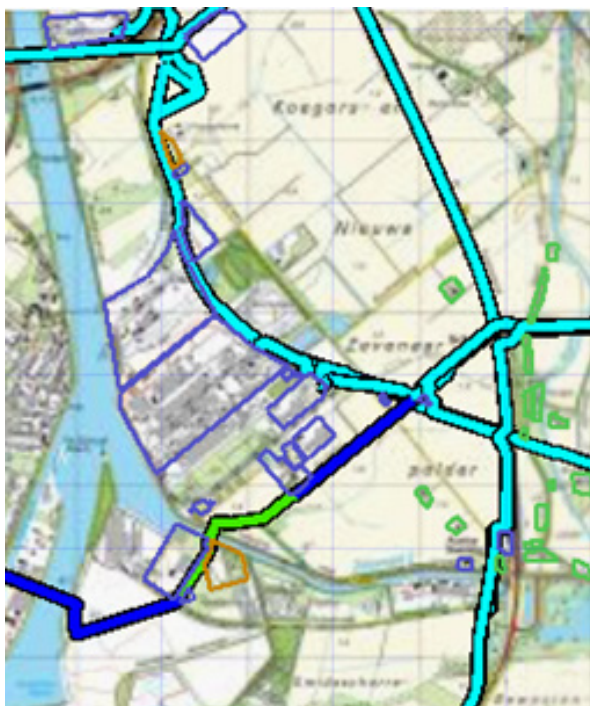
Figuur 5.11 Kilometer leiding behorende bij de maximale overschrijding van de FN-curve voor Z-552-01 van N.V. Nederlandse Gasunie
