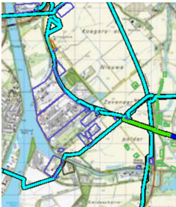
Figuur 5.14 Kilometer leiding behorende bij de maximale overschrijding van de FN-curve voor Z-554-01 van N.V. Nederlandse Gasunie
