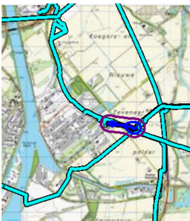
Figuur 4.2 Plaatsgebonden risico voor A-642-01 van N.V. Nederlandse Gasunie
