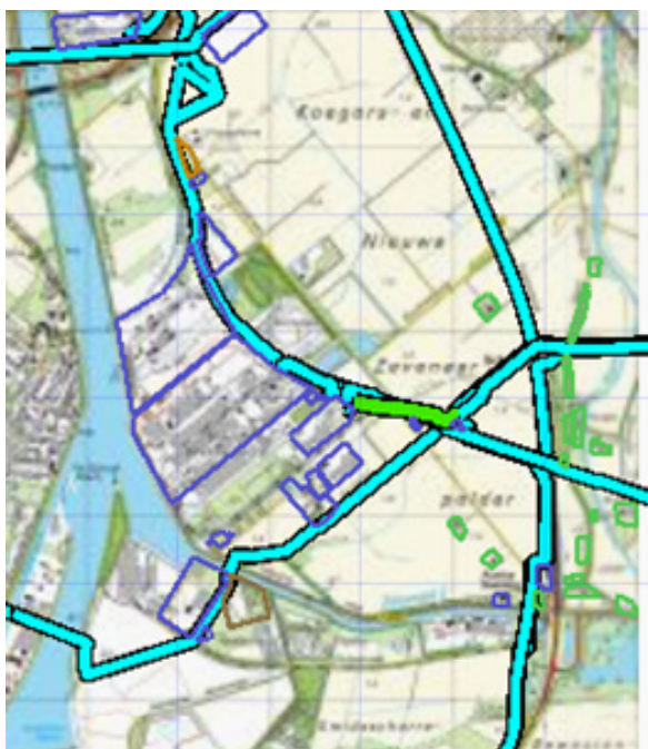
Figuur 5.5 Kilometer leiding behorende bij de maximale overschrijding van de FN-curve voor A-642-01 van N.V. Nederlandse Gasunie
