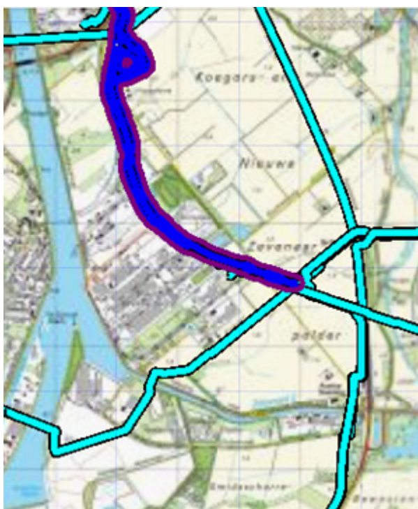
Figuur 4.6 Plaatsgebonden risico voor Z-555-01 van N.V. Nederlandse Gasunie
