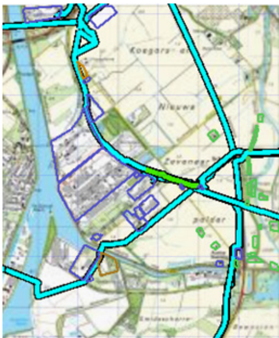
Figuur 5.20 Kilometer leiding behorende bij de maximale overschrijding van de FN-curve voor Z-555-11 van N.V. Nederlandse Gasunie
