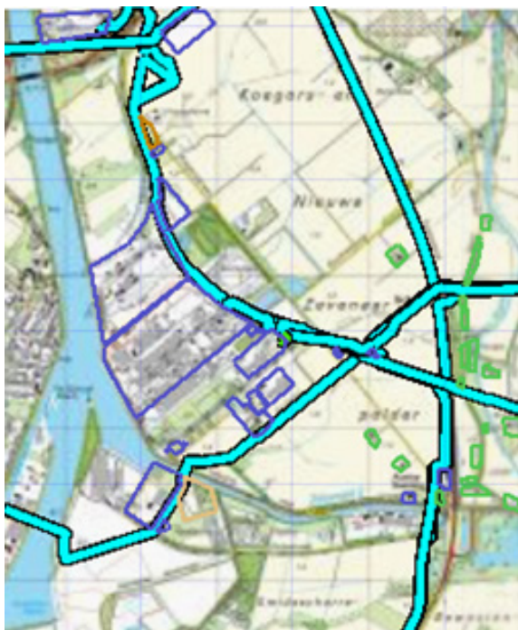
Figuur 5.8 Kilometer leiding behorende bij de maximale overschrijding van de FN-curve voor A-642-05 van N.V. Nederlandse Gasunie
