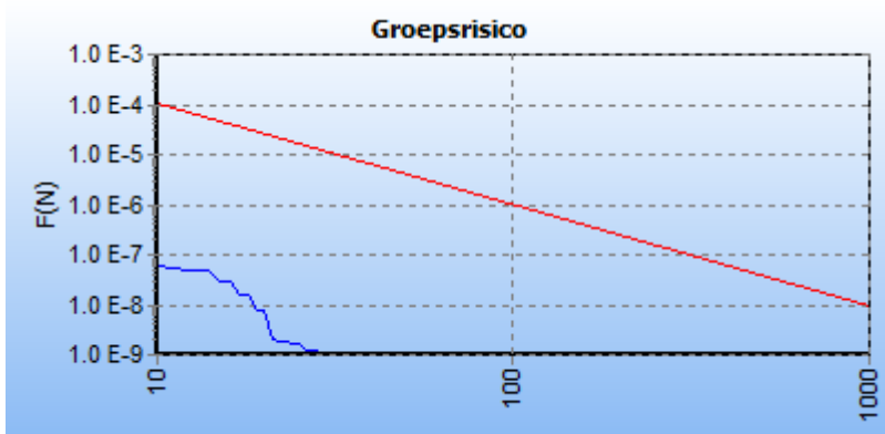
Figuur 5.6 FN curve voor A-642-01 van N.V. Nederlandse Gasunie voor de kilometer tussen stationing 0.00 en stationing 590.00
