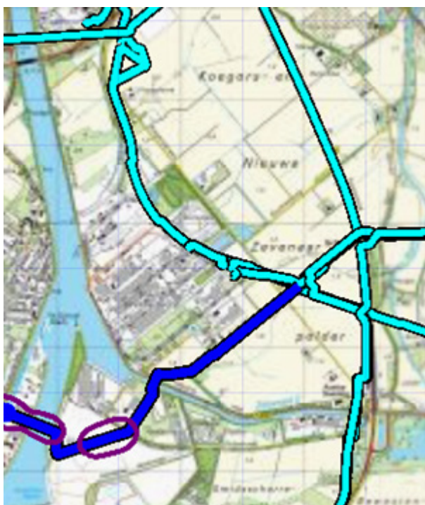
Figuur 4.4 Plaatsgebonden risico voor Z-552-01 van N.V. Nederlandse Gasunie
