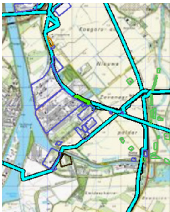
Figuur 5.23 Kilometer leiding behorende bij de maximale overschrijding van de FN-curve voor Z-555-13 van N.V. Nederlandse Gasunie
