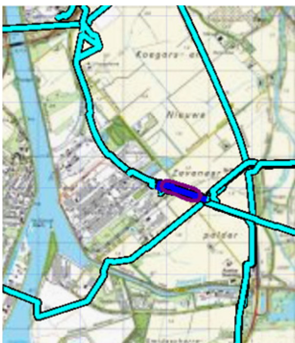
Figuur 4.1 Plaatsgebonden risico voor A-530-09 van N.V. Nederlandse Gasunie
