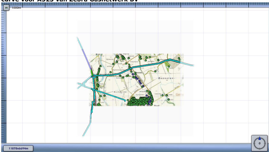
Figuur 4.12 Kilometer leiding behorende bij de maximale overschrijding van de FN-curve voor A523 van Zebra Gasnetwerk BV
