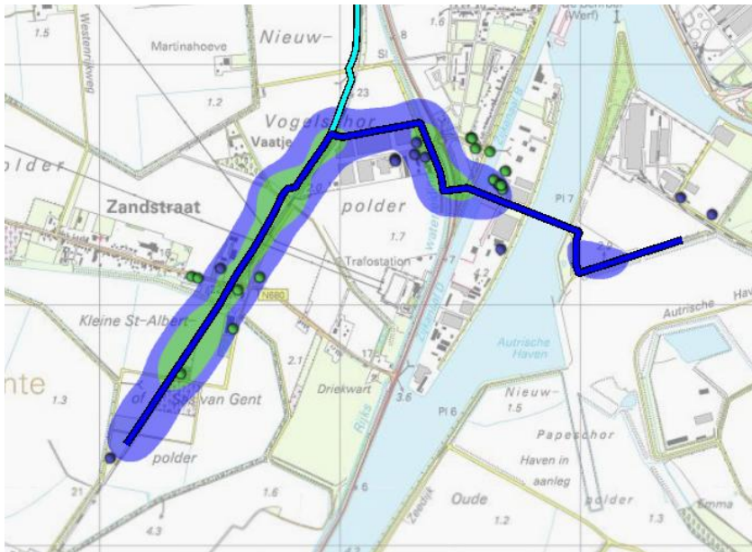
Figuur 4 Ligging van gastransportleiding Z-552-01 (donkerblauw). De contouren van het PR van 10-7 en 10-8 per jaar van de leiding worden respectievelijk weergegeven met groene en blauwe gebieden.
